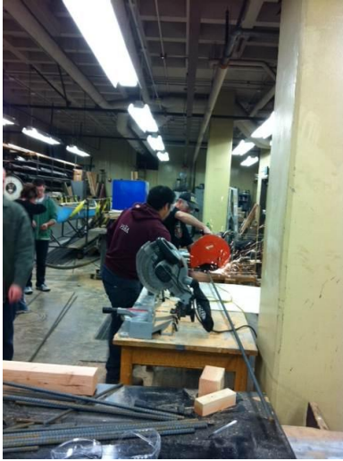
a: Rebar Cutting
